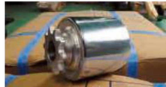
▲チェン駆動ローラ(Hcrメッキ) φ60(肉厚パイプ使用)#40-10S 表面焼入れ後Hcrメッキ処理(前バフ後バフ仕上げ)
