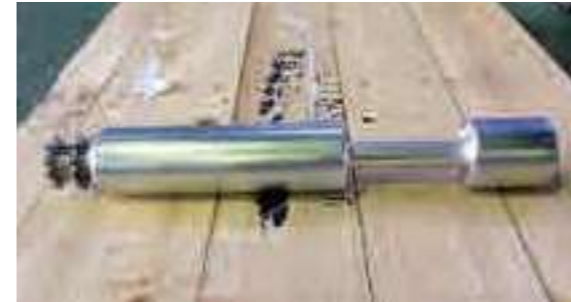
▲2つ割チェン駆動ローラ φ57(ポストジグパイプ使用)#40-10SW φ57(PZ)のパイプを繋ぎ2つ割り形状に仕上げ
