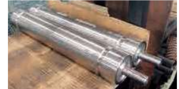
▲溝付きプーリー③(両端2ヵ所) φ140×W600(肉厚パイプ)プーリーのパイプに直接V溝(M型)加工
