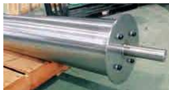
▲ガイド付プーリー②(ガイドボルトドメ) φ165×W1450プーリーに両側6t φ190のガイドをボルトにより固定
