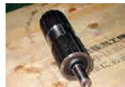
▲特殊プーリー① φ114×W500(肉厚パイプ使用)の溶接プーリーに両側スプライン加工(18ヵ所)
