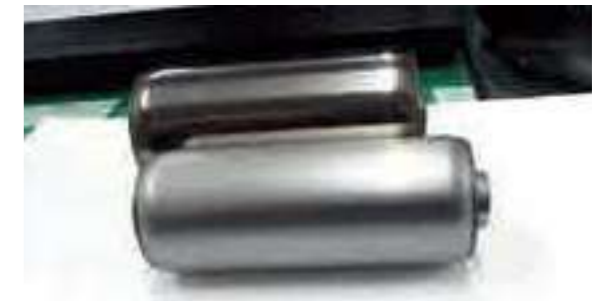
▲フリーローラ①(SUS製・アルミ製) 上:SUS製フリーローラFFU6012-BB120(パイプ:SUS304 #400φ60.5×1.5tを使用) 下:アルミ製フリーローラ特FFA3812-BB108(パイプ:アルミ A6063SB2アルマイト付φ38×1.6tを使用)
