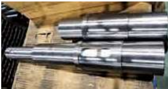
▲車輪用各種軸(駆動用・従動用) S45C調質材から削り出しの駆動用・従動用シャフトの加工
