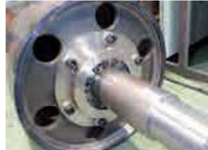
▲ヘッドプーリー②(パワーロック) φ508×W1200のヘッドプーリー 軸と鏡板との接合にボルト固定のハウジングとパワーロックを使用
