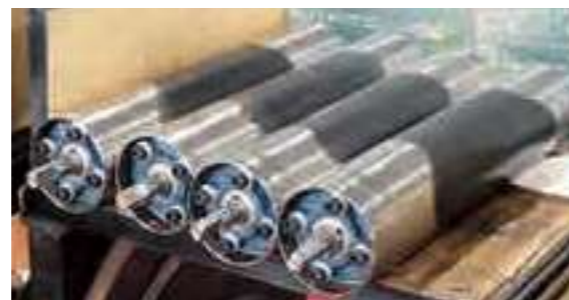
▲テールプーリー②(ベアリングユニット) φ114×W600プーリーに市販品のベアリングユニットを取付
