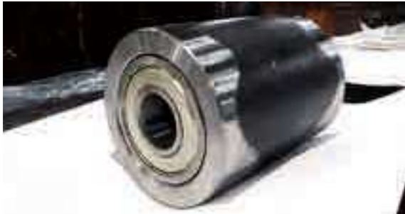
▲ベアリング直バメローラ① クラウン加工付 φ85×15t(肉厚パイプ)にベアリング#6305を圧入
