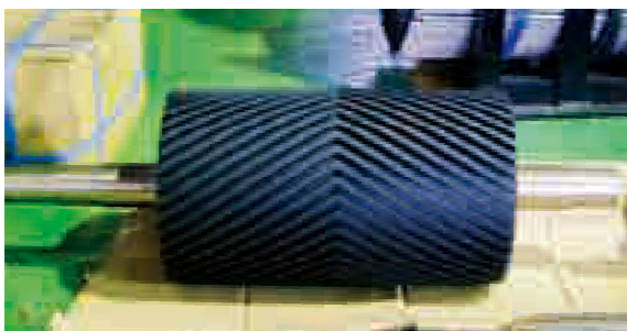
▲プーリー①(Wヘリカルゴム) 芯金φ406×W600に肉厚10mmのWヘリカルゴム(NR)をライニング
