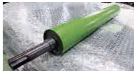
▲プーリー④(テフロンコーティング:緑) φ60×500Wの駆動プーリーにテフロン加工(緑色)処理
