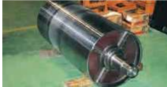
▲ヘッドプーリー①(ボス+リブ4枚溶接) φ406×W1000のヘッドプーリー φ150のボスとリブで補強
