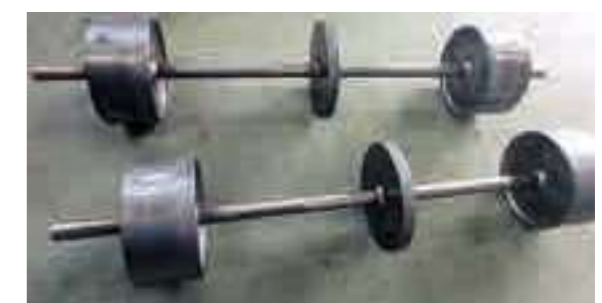
▲3連プーリー 両側のパイプはφ165×W100を使用し中心は22mmの板を溶接した3連プーリー
