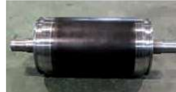
▲溝付きプーリー②(両端2ヵ所) φ140×W260プーリーの両側に溝用のボスを溶接しV溝(M型)加工
