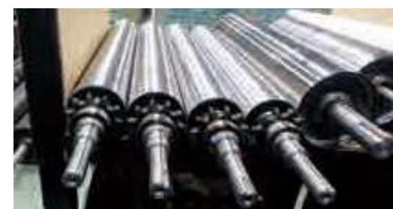
▲スプロケット付プーリー φ82.5×W600のプーリーに#60-11Sスプロケットを溶接
