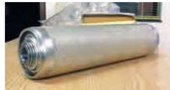
▲フリーローラ②(アヤメローレット) φ60(軸径φ17)フリーローラ表面にローレット加工後 ユニクロメッキ処理
