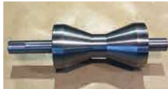
▲削出しローラ 丸棒(S25C材)φ90×W250 丸棒より削出し中心にR加工
