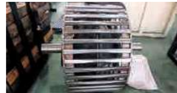
▲カゴ型プーリー正面 φ500×W400(丸棒φ25×30本)切削によるクラウン加工のカゴプーリー カゴの内部にはテーパ管を溶接し外側へ排出する構造のプーリーです
