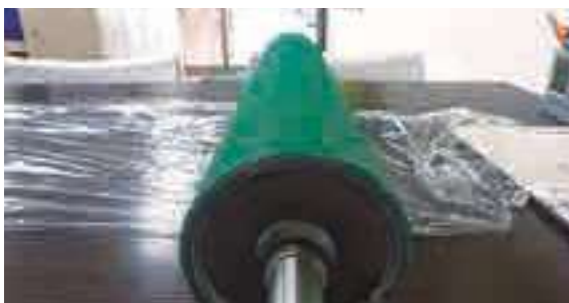
▲プーリー③(グリップタイト巻:緑) φ140×900Wのプーリーにグリップタイト(緑色)巻
