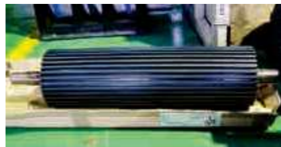
▲プーリー②(横溝ゴム) 芯金φ267×W750に肉厚10mmの横溝ゴム(NR)をライニング
