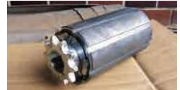
▲チェン駆動ローラ(スプライン加工) φ57(肉厚パイプ使用)#40-10S 表面に8等配のミゾ(巾5×深さ3)加工
