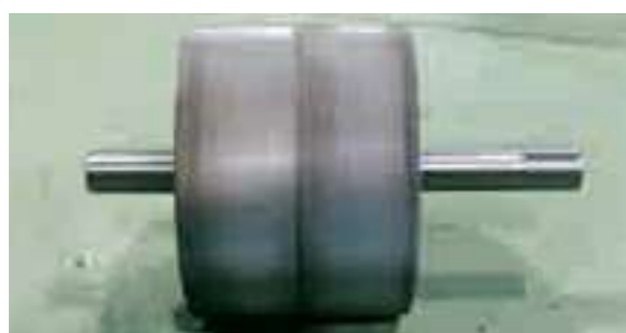
▲ヘッドプーリー(ローレット加工) φ318×W400のプーリーを外径ストレート加工後にアヤメローレット加工
