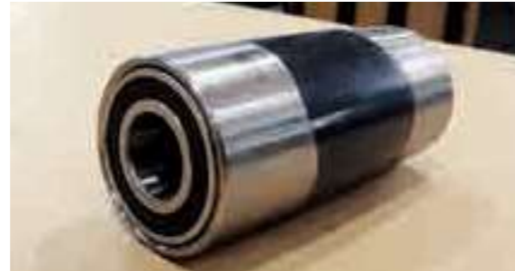
▲ベアリング直バメローラ② クラウン加工付 φ48.6×5.5t(肉厚パイプ)にベアリング#6204を圧入
