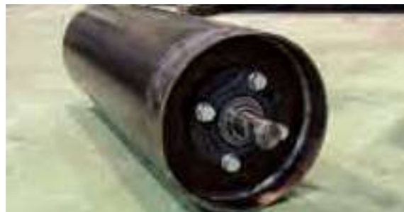
▲テールプーリー①(ベアリングユニット) φ267×W1200プーリーに市販品のベアリングユニットを取付
